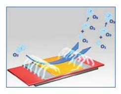
Tal como se muestra en la figura, la formación de las moléculas de ozono se produce por el paso de aire (que contiene un 21% de O2) por un arco voltaico de al menos 7000V, que divide las moléculas de oxígeno (O2) en átomos de oxígeno simple (O1). Ya que el oxígeno es inestable, para estabilizarse tiende a ligarse con otros átomos iguales, hasta formar moléculas estables. El ozono, por lo tanto, es una molécula formada por 3 átomos de oxígeno (O3).
